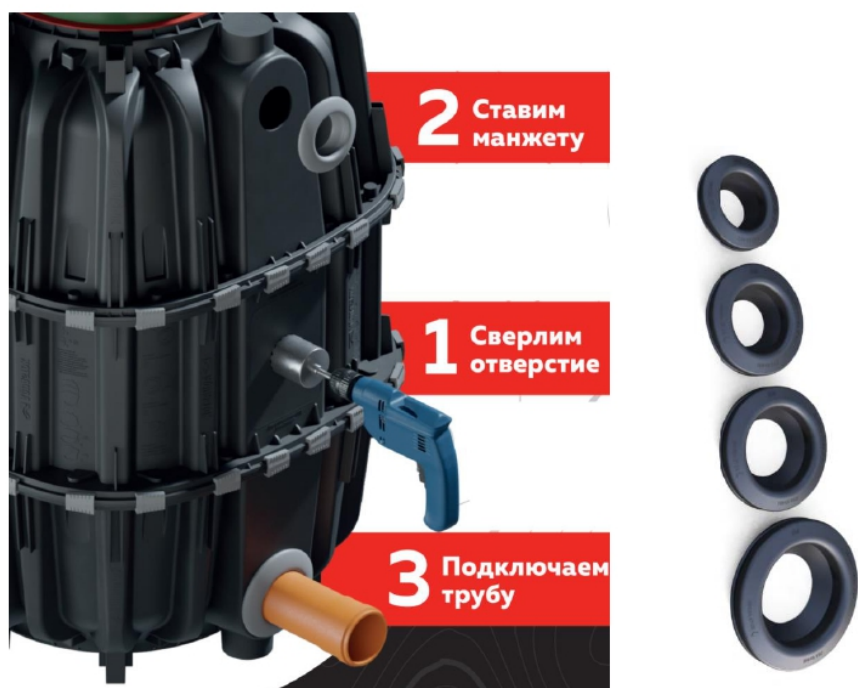
Рисунок 12 – Подключение труб в колодец через адаптеры
